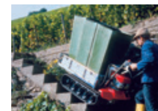
Bandkärran HP 500 har väggrepp även på en sluttning
