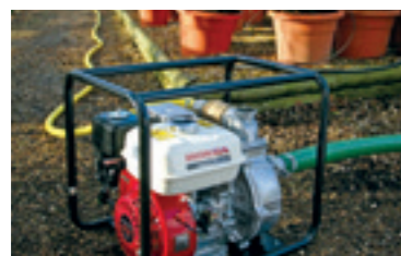
WH-serien erbjuder upp till 5 bars tryck, perfekt för att transportera vatten långa sträckor
